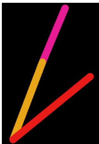
Figura 1.9 - Configurazione limite quadrilatero con rotazione in O
